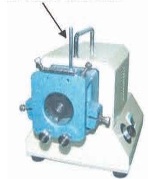
2. 粉碎室のフタを開け、カッティングヘッドのスクリューを緩め、外して下さい。
