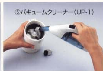
⑤バキュームクリーナー(UP-1) 粉砕した試料を取り出し、付属のクリーナブラシで掃除の後残った少量の試料をこのミニバキュームクリーナー(UP-1)で吸引します。ミニブレンダー、ワンダーブレンダー専用のバキュームクリーナーです。
